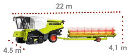
Dimensions d'une moissonneuse-batteuse avec chariot de coupe
